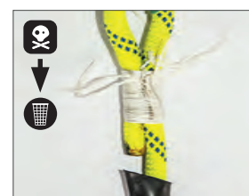
縫製処理済の末端の縫製が裂けている
